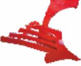
Killi (yapışkan) ve ağır toprak koşullarında parçalı yapısı sayesinde sürtünme yüzeyini azaltarak toprağın kulak yüzeyine yapışmasını önler ve traktör çeki gücünden ekonomi sağlar.
